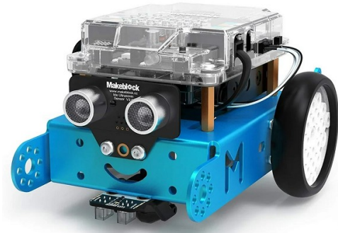
Robot ( carte, moteur, roue)
