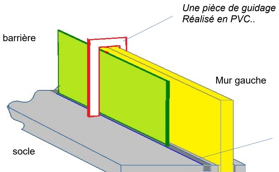
La barrière en polystyrène choc est guidée au sol par une rainure
