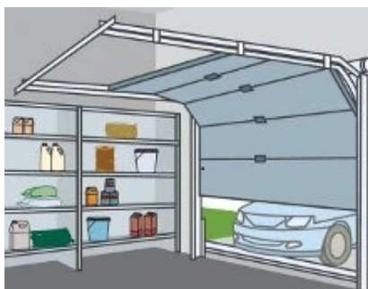
Figure 3 : ouverture d'une porte de garage sectionnelle
