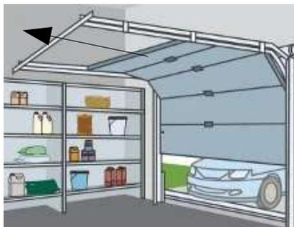
Figure 3 : ouverture d'une porte de garage sectionnelle
