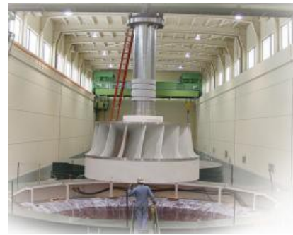
figure 7 turbine d'une centrale hydroélectrique
