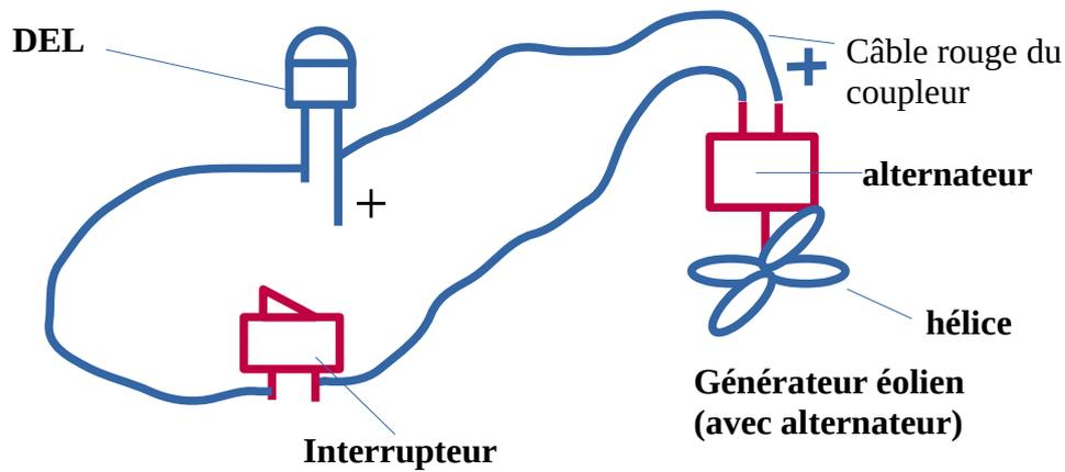
**Ces montages électriques peuvent être exprimés à l'aide de schéma structurel**
