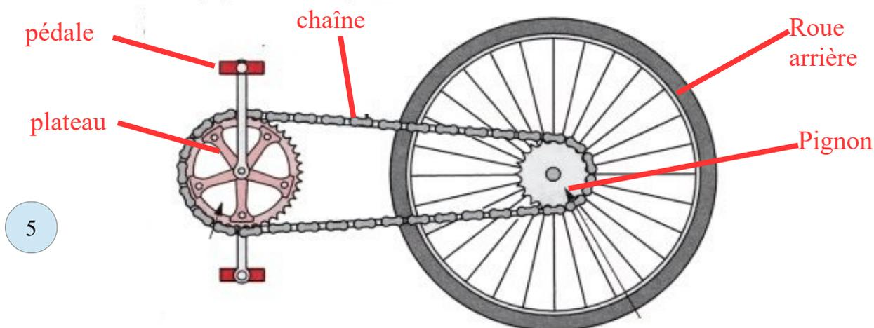
a) essayez de décrire le **principe de fonctionnement de ce système**, c'est à dire comment le mouvement des pieds du cycliste fait tourner la roue
