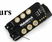
**Principe d'un détecteur :** La LED émettrice envoie une lumière infrarouge que le sol réfléchit en direction du phototransistor qui capte ainsi la quantité de lumière en retour.
